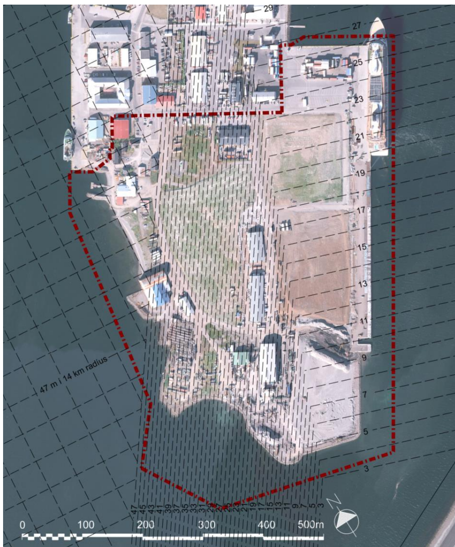
Mynd 2-5 Hindranaftletir Ísafjarðarflugvallar. Hæð leyfilegra mannvirkja er sýnd í metrum.
