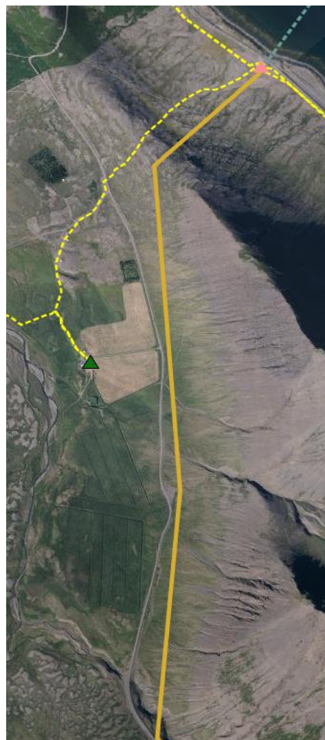
Mynd 5. Heil lína sýnir 33 kv háspennu línu frá Mjólká. Brotin lína sýnir 11 kv jarðstreng frá Þingeyri. Af kortasjá OV.
