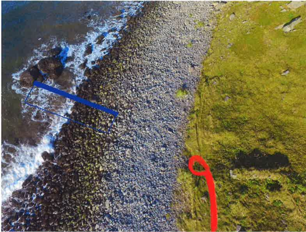
Mynd 5. Rauða línan táknar slóða sem ætlunin er að styrkja svo hann skemmist ekki meira, bláa er þar sem ætlunin er að steypa plötu og stoðvegg út að stóru steinunum í fjörunni.
