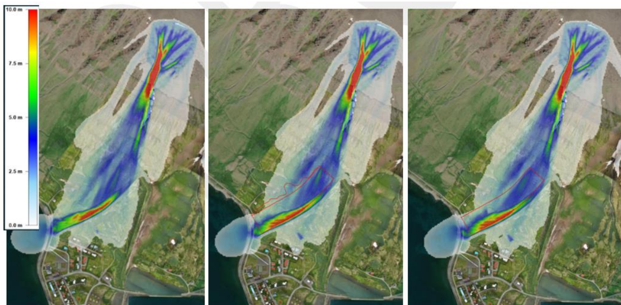
Mynd 19 Líkanhermun af 150 þús. m 3 snjóflóði með endurkomutíma <100 ár. Mesta flóðdýpt í farvegi sýnd. Til vinstri: Núverandi fyrirkomulag. Miðja: Víkkun flóðrásar. Til hægri: Víkkun og dýpkun rásar
