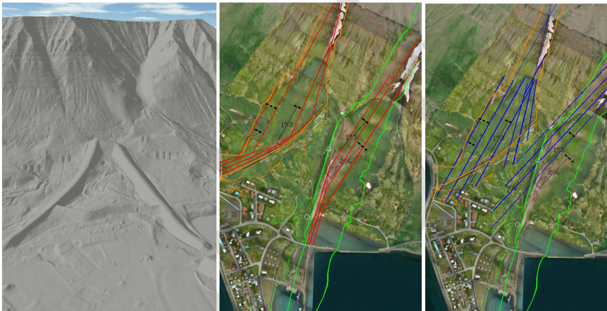
Mynd 11 Drög að uppröðun keilna ofan varnargarða. Útlínur snjóflóðanna 15. Janúar 2020 eru sýndar með appelsínugulum og grænum línum. Rauðar línur sýna stefnu þétts kjarna og bláar línur áætlaða stefnu iðufalds
